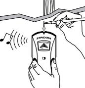
Si no soltar el botón de encendido/apagado, continúe explorando más allá del punto marcado hasta que se apague la luz roja que indica el borde "EDGE". Deslice la unidad en dirección opuesta hasta que localice el otro borde de la viga.
