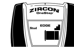
Continúe deslizando la herramienta. Cuando se localice el centro de la viga se muestran tres barras del Indicador de Potencia de la Señal, y las cuatro barras centrales, la pantalla CENTER (centro), y el SpotLite® todos se iluminarán, y el tono sonará.
