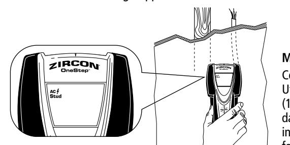
Si la détection démarre au-dessus d'un fil sous tension, l'indicateur AC clignotera en continu. Pratiquez avec une extrême prudence dans ces circonstances ou si un câblage sous tension se trouve au voisinage.
