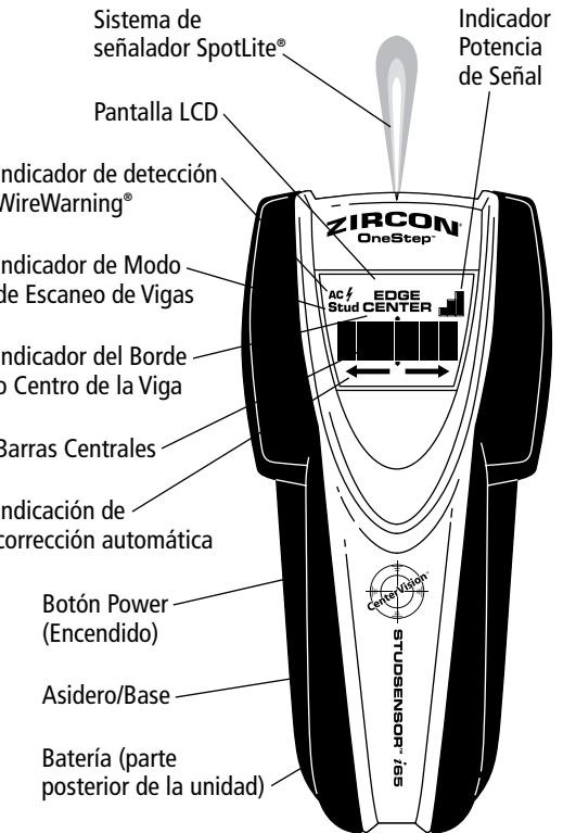
El StudSensor™ i65 OneStep® de Zircon detecta el centro y bordes de vigas en paredes, pisos, y techos en un paso. Viene en un plástico resistente de alto impacto y con el sistema patentado de señalamiento SpotLite®.
