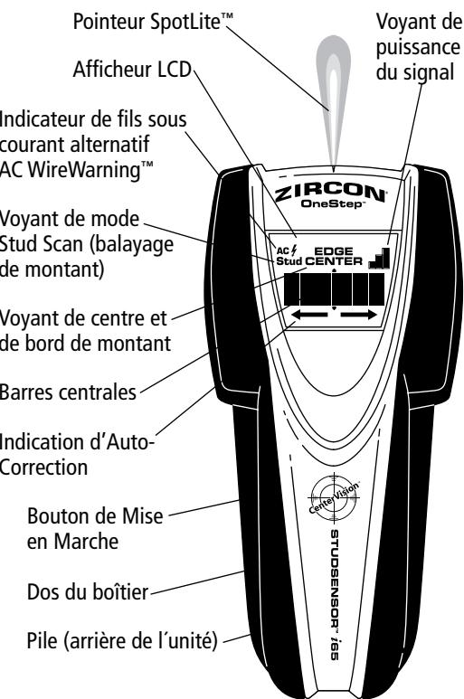
Le StudSensor™ i65 OneStep™ Zircon indique à la fois les bords et le centre de pièces de bois ou métal et solives dans murs, sols et plafonds en une seule opération. Il présente un boîtier anti-choc solide et le système breveté de Pointeur SpotLite™.
