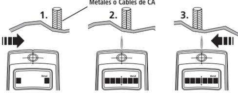
En el modo METAL SCAN (escaneo de metales), si calibra directamente sobre el metal, probablemente no detectará ningún metal. Mueva la herramienta algunas pulgadas hacia la izquierda o la derecha, deje de oprimir el botón de encendido y comience nuevamente.
